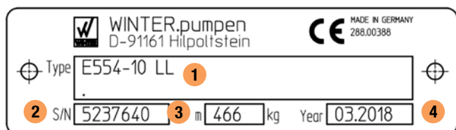
Abbildung 9: Beispiel eines Typenschildes an Aggregaten
