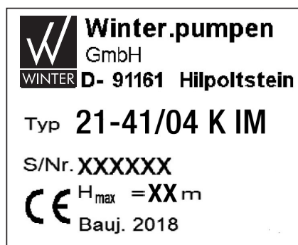
Abbildung 4: Beispiel eines Typenschildes an der Pumpe
